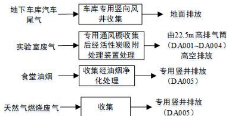
图 4.2-1 本项目废气收集及处理示意图
